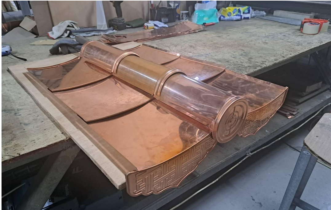
圖 3.3 不鏽鋼金屬瓦乾式施工 1:1 模型大樣
